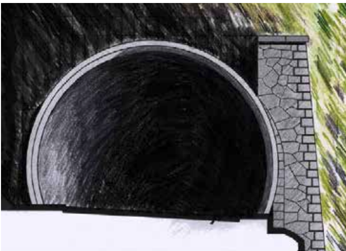
Esquisse de planification et réalisation du portail aval remis en état du tunnel de Wiler au col du Susten
